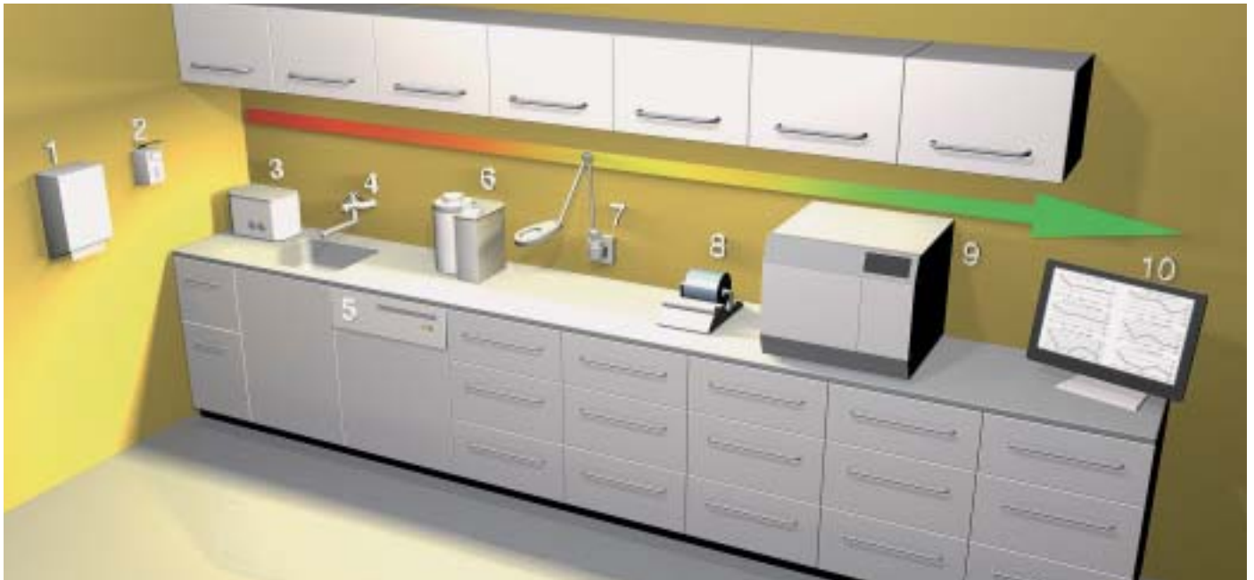
Aufbereitungsraum mit räumlicher Trennung der Prozesse von „unrein“ nach „rein“ – kontaminiert (rot) über desinfiziert (gelb) zu sterilisiert (grün):
