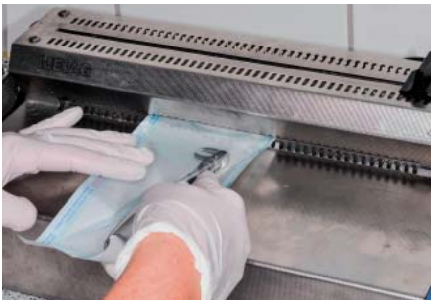
Versiegelung einer Folienverpackung mit einem Balkensiegelgerät.
